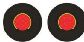
Semáforos especiales Para cruce ferroviario
